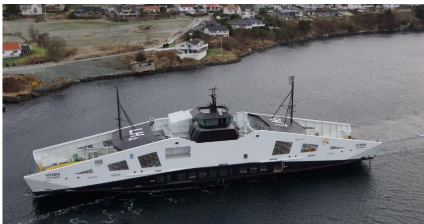
Figur 6 - Hydra bruker brenselceller og hydrogen som drivstoff
